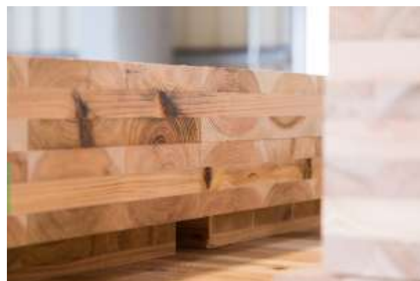
銘建工業で製造した CLT。国産材を使用し、 耐震性にも優れた木質建材です。
