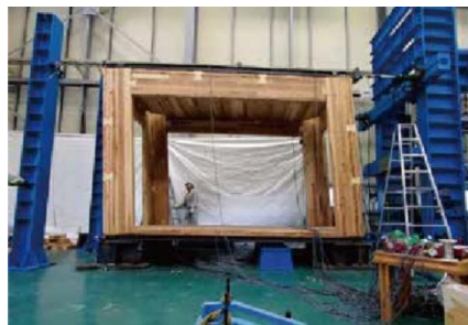
CLT を使用した箱型ユニットの耐震実験の様子
