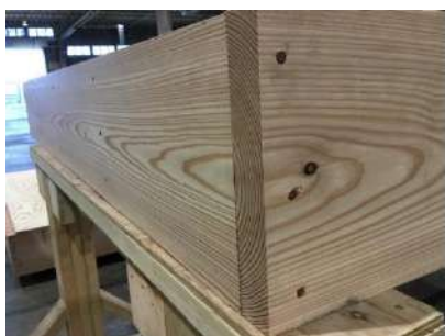
国産材 (カラマツ) の枠組壁工法用製材 (2×10材) による床パネル
