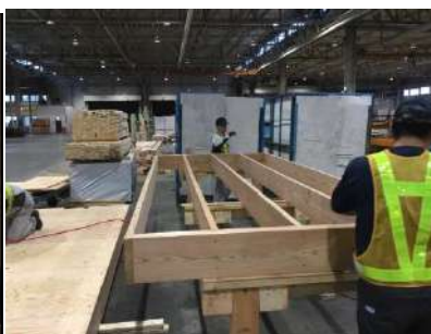
国産材 (カラマツ) の枠組壁工法用製材 (2×10材) による床パネル
