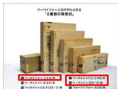
枠組壁工法 6種類の規格材
