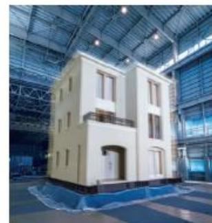
2階建よりも地震の影響を受けやすい3階建の建物で耐震実験を実施。震度7の揺れに連続29回も耐え抜くことを実証しています。
