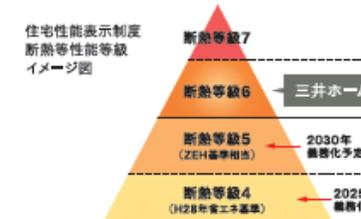
「三井ホーム セレクト」の断熱性能は、「断熱等級6」。これは2025年に義務化される「断熱等級4」、2030年に義務化予定の「断熱等級5(ZEH基準相当)」を上回る高水準の性能です。
